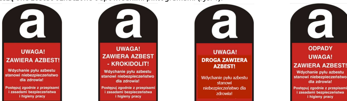
Rysunek 1 Piktogramy służące do oznakowania instalacji lub urządzeń, rur azbestowych, dróg i odpadów zawierających azbest
